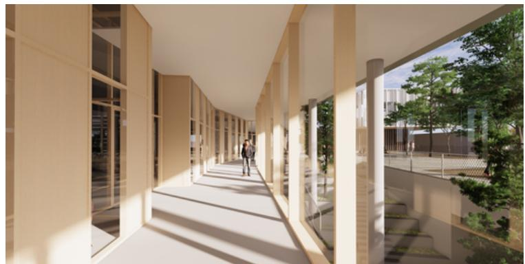
Pour ce projet, l'impact carbone de la construction est réduite par la mise en œuvre d'une structure poteaux-poutres en béton bas carbone et des façades en bois en panneaux CLTi type PANOBLOC isolé en laine de bois. Les logements possèdent également une structure en bois.
